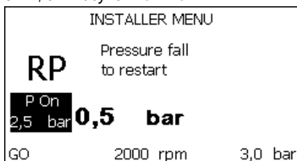
Рисунок 18.1: Настройка давления нового включения (2)
