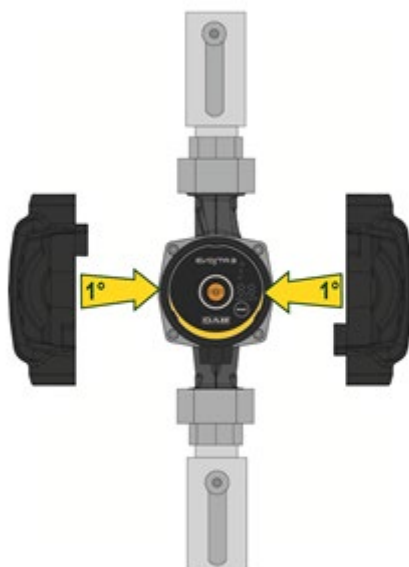
Figura 7: Isolamento do corpo da bomba
